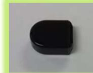
体内埋込み型運動量計測装置 (18.8mm × 14.2mm × 7.1mm)
